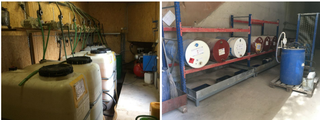
Abbildung 4: Lagerung von Zusatzmitteln (links) und Betriebsstoffe (rechts)
