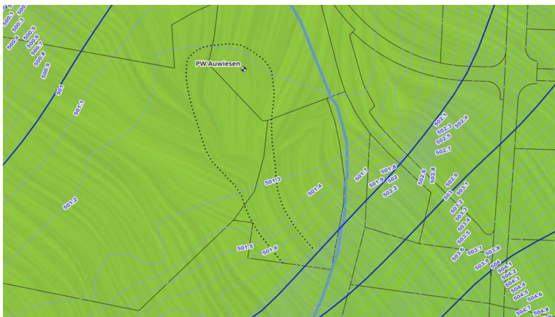
Abb. 13: Schlierendarstellung im Bereich der Grundwasserfassung PW Auwiesen. Dargestellt sind die Grundwasserisohypsen der Modellschicht 8 des Referenzmodells, sowie das sich in dieser Modellschicht ergebende Brunneneinzugsgebiet und der Verlauf der Lützelburg (hellblaue Linie).
