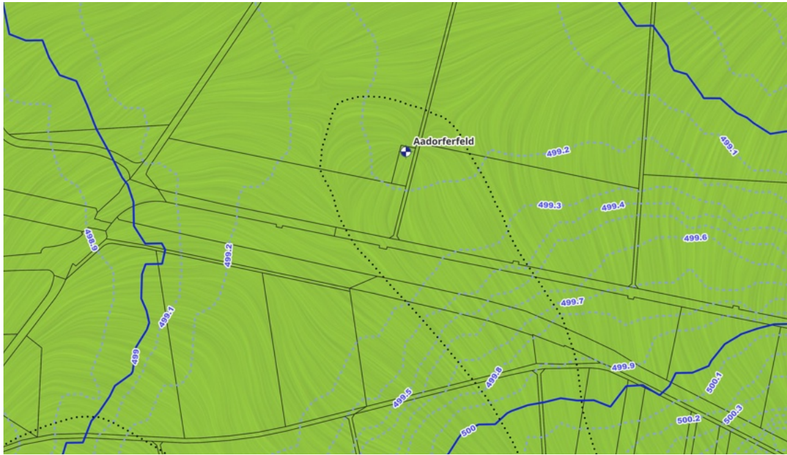
Abb. 16: Schlierendarstellung im Bereich der Grundwasserfassung Aadorferfeld. Dargestellt sind die Grundwasserisohypsen der Modellschicht 9 des 1st Szenario, sowie das sich in dieser Modellschicht ergebende Brunneneinzugsgebiet.
