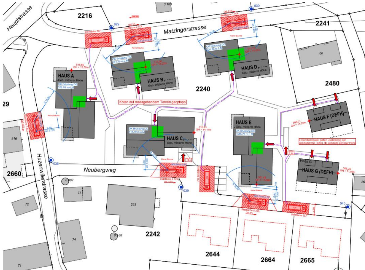
Abbildung 20: Feuerwehrstellplätze Brandschutz Konzepte AG
