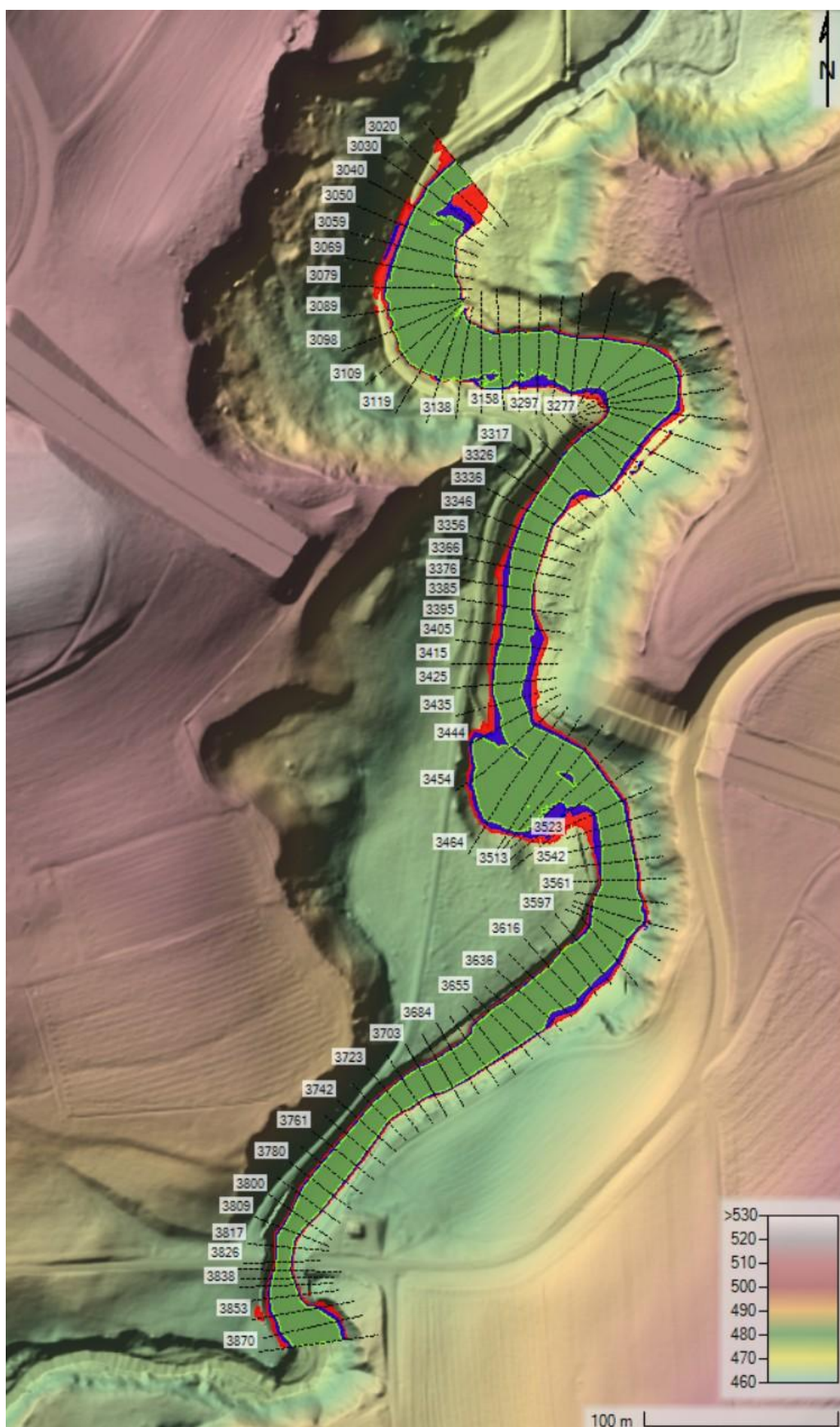
Abbildung A1: Resultate aus 1D-Modellierung (Olivgrün: HQ 30 , Dunkelblau: HQ 100 , Rot: HQ 300 )
